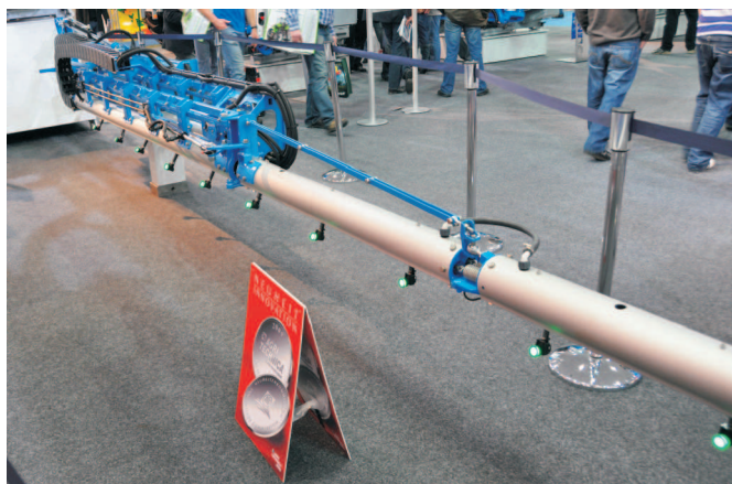
Rys. 5. Bezstopniowa regulacja belki opryskiwacza „VariExtend” firmy Lemken
