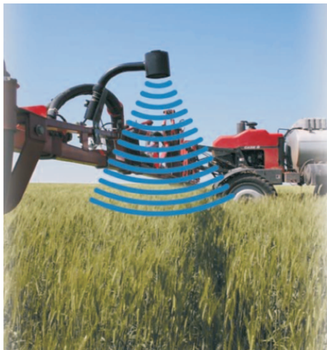
Rys. 4. Układ sterowania belką polową UC4+ firmy Norac z Kanady
