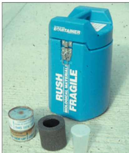
Ryc. 9. „Equitainer” plastikowy termos do transportu schłodzonego nasienia
