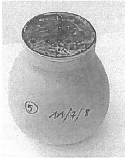
Rys. 6. Widok przygotowanej i oznaczonej próbki nasion gotowej do umieszczenia jej w komorze ciśnieniowej.
