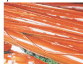
Rys. 2. Walce zgniatające stanowiące wyprofilowane kształtowniki: a - firmy Westward, b, c - firmy Hesston
