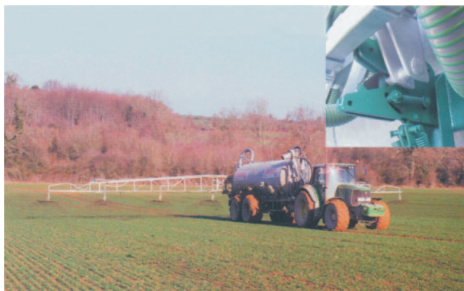
Rys. 4. Rampa z dyszami rozbryzgowymi pozwala na rozlewanie gnojowicy na powierzchni na szerokości od 12 do 24 m (system Gre firmy Jeantil) Fig. 4. Ramp with splashing nozzles lets spilling slurry on the surface on the breadth from 12 up to 24 m (Gre system of the Jeantil company)
