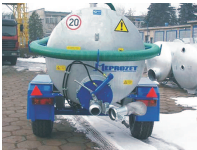
Rys. 1. Wóz asenizacyjny firmy MEPROZET ze stożkiem rozlewowym
