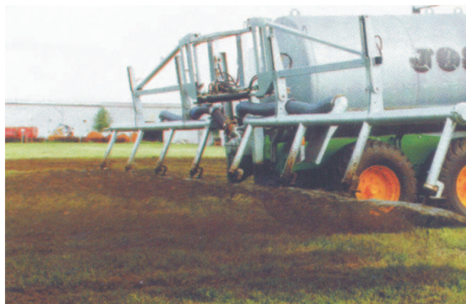
Rys. 6. System Multitwist firmy Joskin zapewnia równomierne rozmieszczenie gnojowicy na powierzchni
