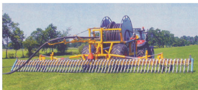
Rys. 3. Agregat ciągnikowy do aplikacji gnojowicy z rurociągiem umieszczonym na ciągniku duńskiej firmy Kyndestoft Maskinfabrik ApS Fig. 3. Tractor Unit to the slurry application with the pipeline put on the tractor of the Danish company Kyndestoft Maskinfabrik ApS
