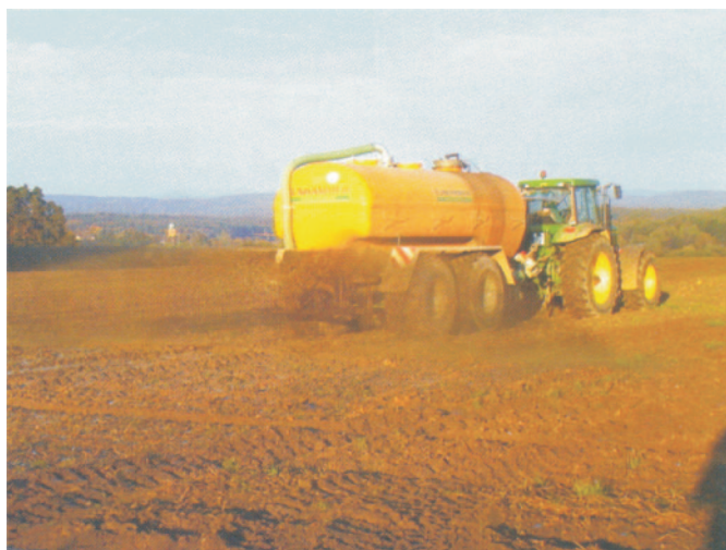
Rys. 2. Wóz asenizacyjny firmy Zunhammer wyposażony w rozdzielacz głowicowy Fig. 2. Sewage Cart of the Zunhammer company equipped with the head distributor
