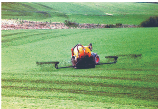
Rys. 5. Nisko zawieszona rama z płytkami rozbryzgującymi zwiększa regularność rozlewania (system firmy Veenhuis) Fig. 5. Low position of the hung frame with splashing tiles is increasing regularity of spilling process (system of the Veenhuis company)
