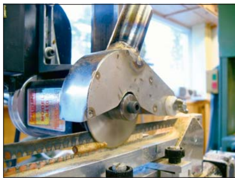
Ryc. 2. Docinanie wywiertów piłą dwutarczową
