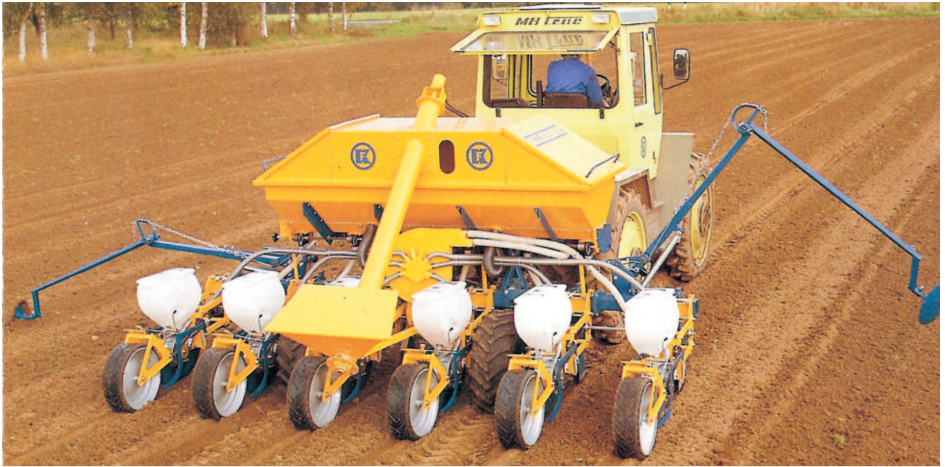
Rys. 5. Siewnik do kukurydzy i innych nasion grubych „MULTICORN”, prod. F. Kleine Maschinenfabrik GmbH&Co.
