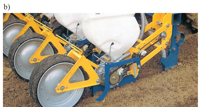
Rys. 4. Siewnik do kukurydzy i innych nasion grubych „MULTICORN”, prod. F. Kleine Maschinenfabrik GmbH&Co: a) przekrój sekcji wysiewającej, b) widok sekcji; 1- zbiornik, 2- tarcza wysiewająca (z otworkami), 3- element zabierający, 4- korektor (odrzutnik), 5- regulacja korektora, 6- przekładnik, 7- koło komorowe, 8- redlica, 9- podciśnieniowy przewód, 10- gleba
