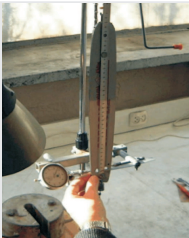
Stanowisko SPP-1 do pomiaru zużycia prowadnicy
