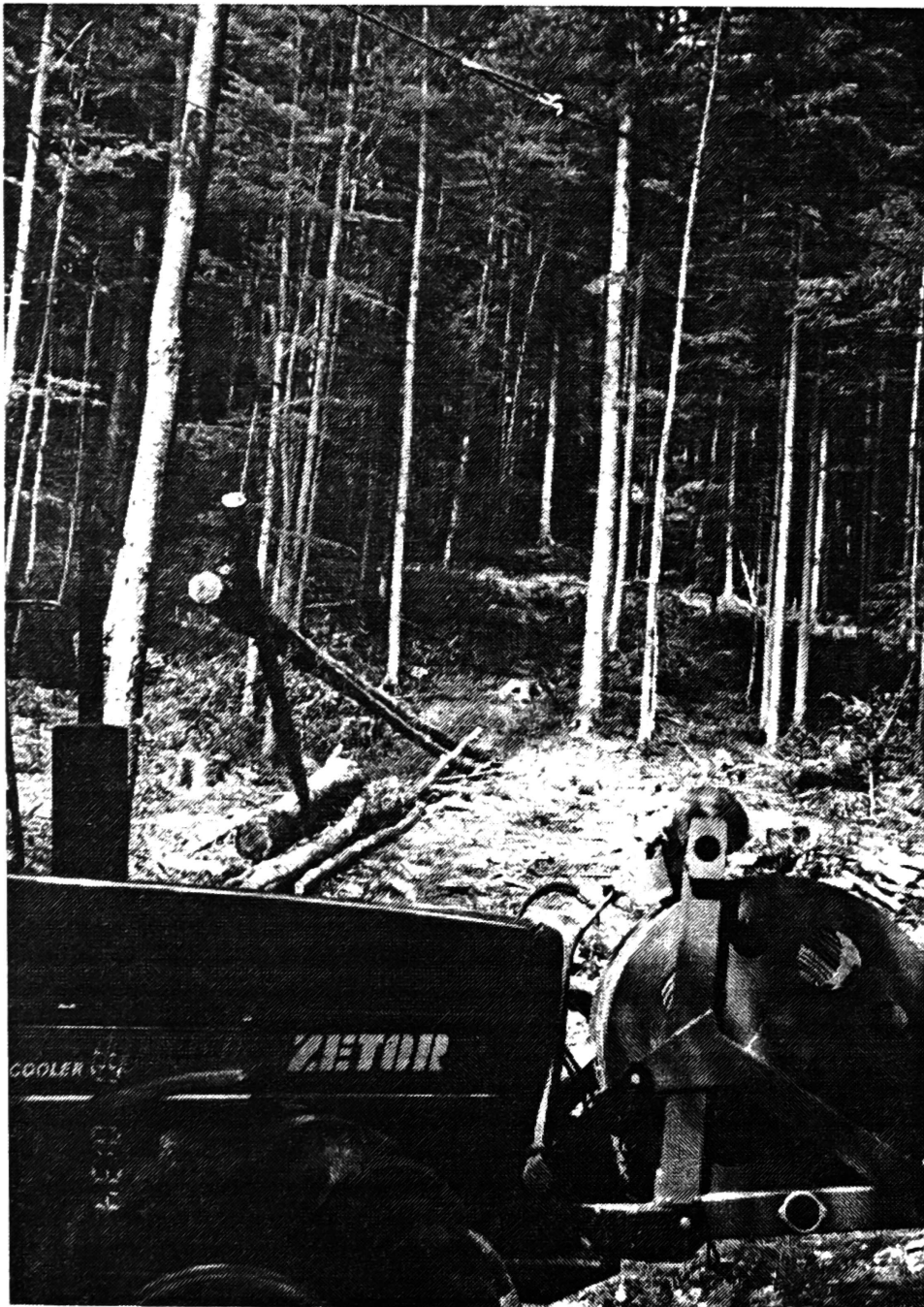
RYC. 1. Kolejka linowa Larix 3T przy zrywce drewna w Bieszczadach (Nadleśnictwo Wetlina)
