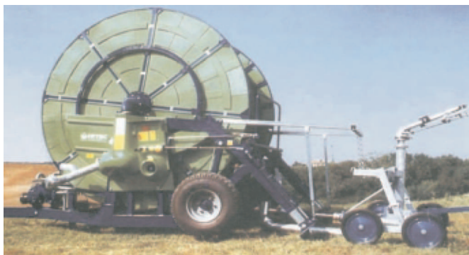
Rys. 6. Deszczownia szpulowa Łukofama do nawadniania upraw rolniczych, warzywniczych i szkółkarskich - bardzo popularna w nawadnianiu ziemniaków
