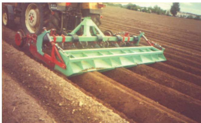
Rys. 2 Obsypnik bierny UFO 97 podczas pracy Fig. 2. UFO 97 passive potato ridger while working
