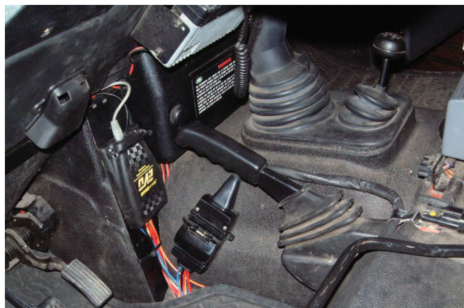
Rys. 3. Sposób montażu sterownika EVO i czujnika siły (Brake Pad) na pedale hamulca w samochodzie LRD 110
