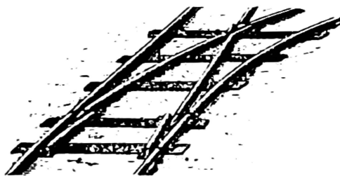
Rys. 3. Zwrotnica bez mechanizmu nastawczego [1]
