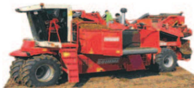
Rys. 4. Samobieżny kombajn do zbioru ziemniaków SE 150-60 (Grimme)
