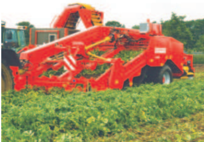
Rys. 5. Samobieżny kombajn do zbioru ziemniaków GV 3000 (Grimme)
