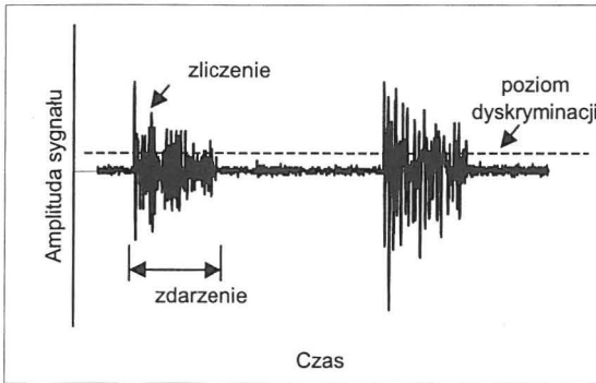
Rys. 1. Wyznaczanie zliczeń i zdarzeń sygnału emisji akustycznej.
