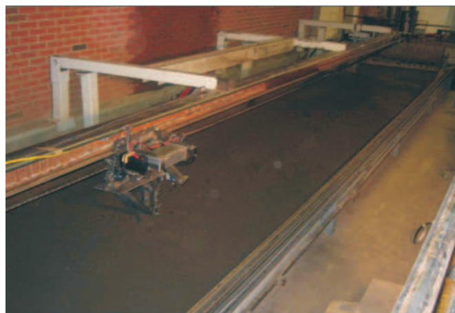
Rys. 2. Kanał glebowy z wózkiem do badań narzędzi przemieszczających się z dużą prędkością [4]
