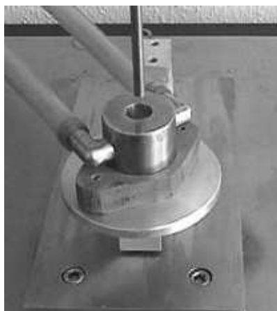
Rys. 2. Komora z płaszczem wodnym utrzymująca stałą temperaturę próbki podczas testu.
