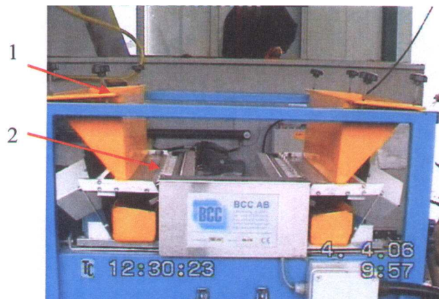
Rys. 4. Zespół wysiewający nasiona w celach kaset: 1 - rynna zasypowa na nasiona, 2 - obudowa z przyrządem komórkowym
