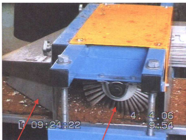
Rys. 2. Część linii technologicznej do wysiewu nasion, a - zespół napełniający kasety substratem, b - zespół zgarniający nadmiar substratu, 1 - dozownik podłoża, 2 - stół wibracyjny, 3 - ubijaki, 4 - listwa zgarniająca, 5 – szczotka
