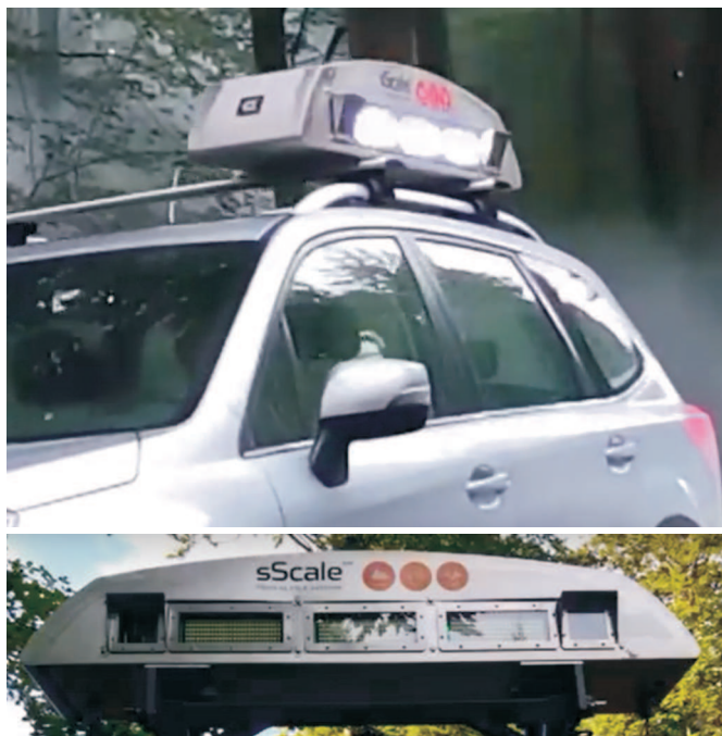
Rys. 2. Zestaw do fotooptycznego pomiaru stosu firmy Dralle Fig. 2. Dralle stack photo-optic measurement set
