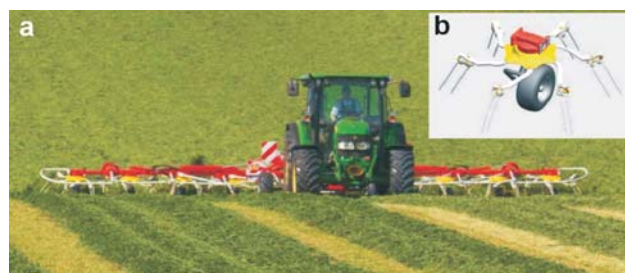
Rys. 7. Przetrząsacz przyczepiany serii HIT T 12 (a) i karuzela dynatech (b) Fig. 7. Trailed tedders series HIT T 12 (a) and rotor dynatech (b)
