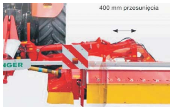
Rys. 1. Zasada regulacji szerokości roboczej kosiarek serii NOVOCAT V [1]
