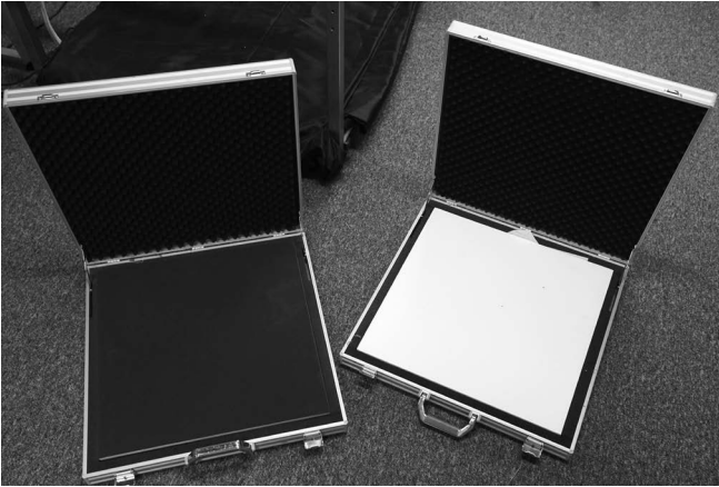
Rycina 2. Znaczniki kalibracyjne o niskiej (<5%) i wysokiej (>95%) reflektancji w zakresie światła widzialnego i podczerwieni wykorzystywane w projekcie HESOFF
