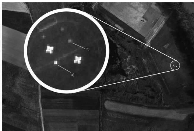
Rycina 1. Terenowe znaczniki kalibracyjne o refleksyjności (a) >95% i (b) <5% sfotografowane z pułapu 800 m
