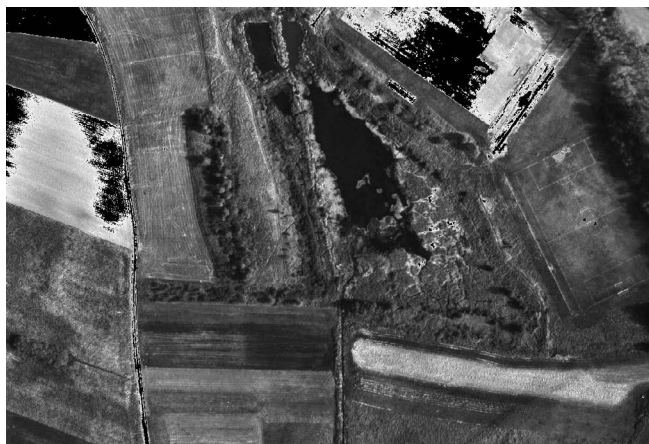
Rycina 6. Kanał 640 nm, wysokość 1200 m, obraz po korekcji algorytmem FLAASH, skala jak na rycinie 1
