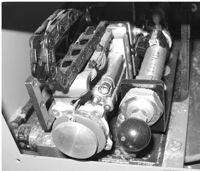
Bild 4. Bestandteile des Messgeräts: links – Schwingungsempfänger, rechts – Klopfkugel
