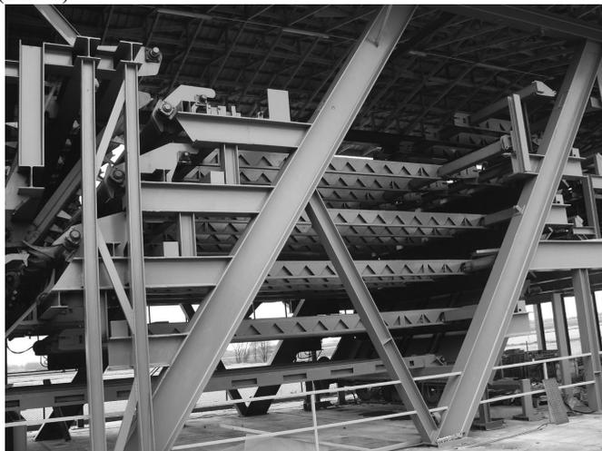
Bild 5. Horizontale Sortierboxen für sortiertes Schnittholz
