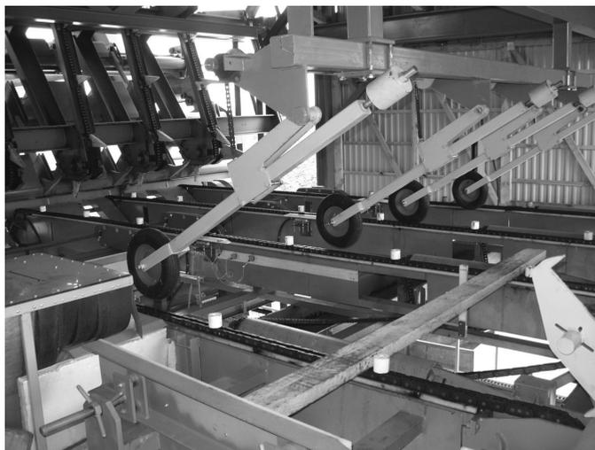
Bild 3. Manipulationsbereich der Sortieranlage (links Gehäuse der Kappsäge)
