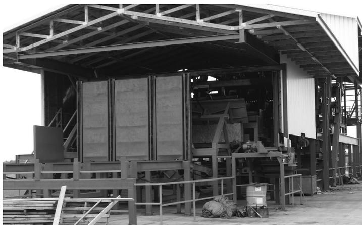
Bild 1. Linie für maschinelle Schnittholzsortierung nach Festigkeit im Sägewerk Witkowsy
