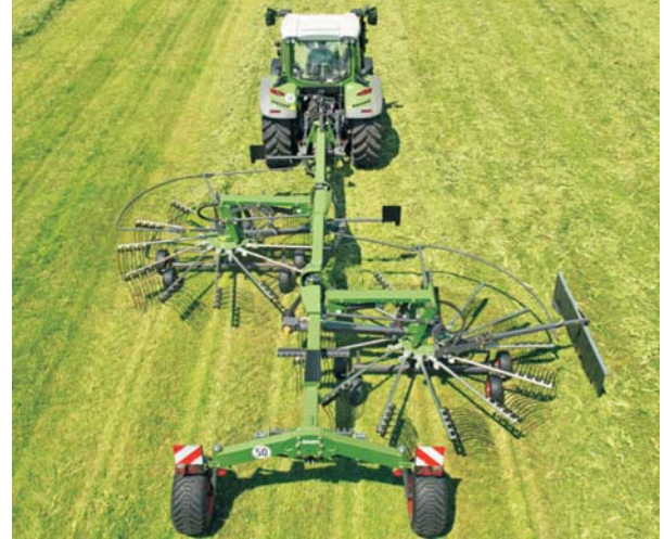
Rys. 10. Zgrabiarka Fendt Former 12555 X z napędem elektrycznym zespołów roboczych [3]
