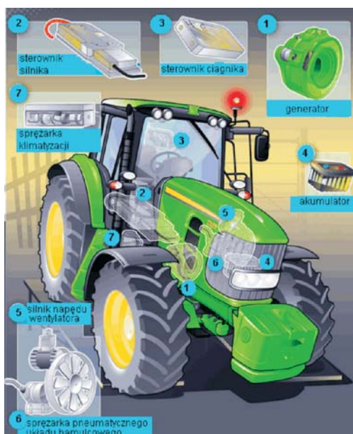
Rys. 1. Ciągnik rolniczy John Deere 7430 E Premium z generatorem elektrycznym [4]
