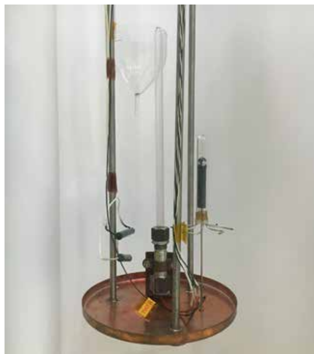
Ryc. 3. Górny obraz: kriostat, dolny obraz: wnętrze kriostatu wraz z instrumentami służącymi do demonstracji właściwości nadciekłego helu. Dzięki uprzejmości TE, CERN.
