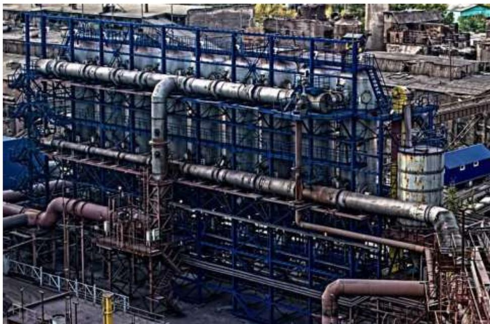
Рис. 3. Общий вид сухой системы очистки доменного газа
