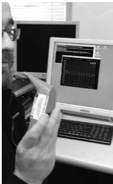
Ryc. 4. „Mysz-dmuchowa” – rozwiązanie dla osób z dysfunkcją rąk i nóg (fot. W. Ł. Nowacka) Fig. 4. “Blow-Mouse” for those with upper and lower limb disability
