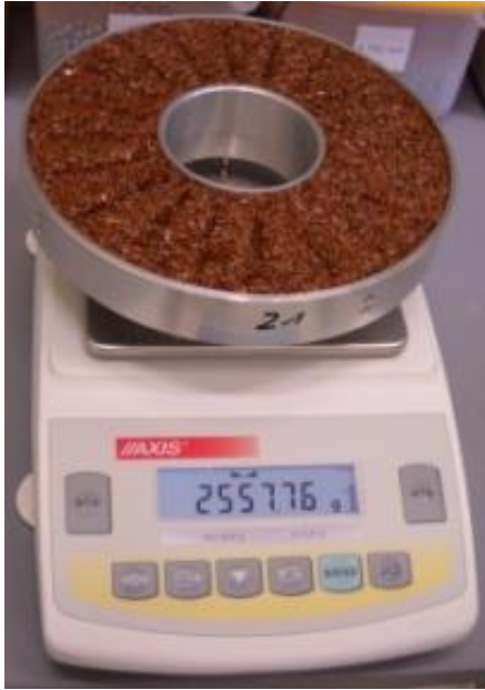
Рис. 3. Взвешивание исследуемого материала на электронных весах Axis
