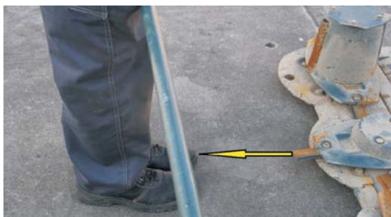
Rys. 3. Bariera kosiarki zabezpieczająca przed przypadkowym dostępem do wirującego noża
