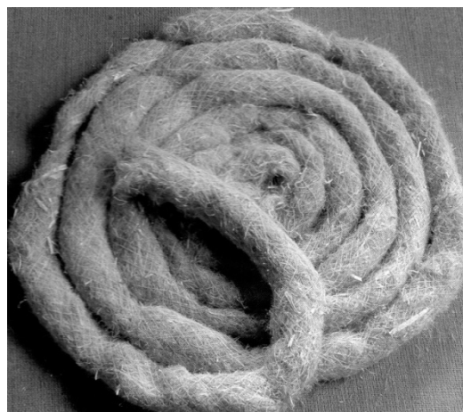
Figure 14. Pipe wrapping made of hemp fibre Rysunek 14. Otulina rur wykonana z włókien konopnych Source: Allin 2012. Źródło: Allin 2012.
