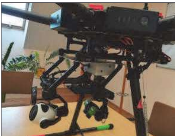
Ryc. 3. Kamera Zenmuse X3 i Double 4K na platformie Matrice 600 Źródło: Opracowanie własne.
