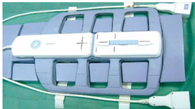
Ryc. 8. Cewka matrycowa do obrazowania narządów w obszarze klatki piersiowej, jamy brzusznej i miednicy.
