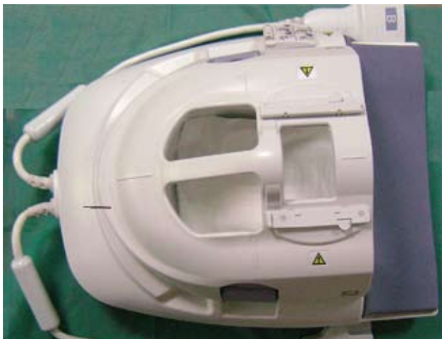
Ryc. 6. Szesnastokanałowa cewka do badania mózgu.
