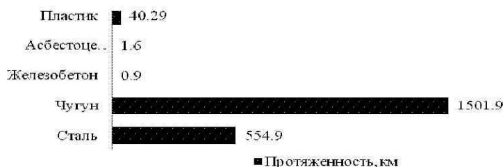
Рис. 2. Материал трубопроводов водоснабжения г. Харькова Fig. 2. Material of Kharkov water supply pipelines
