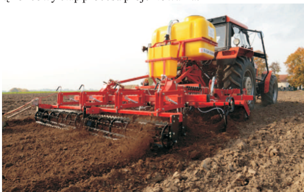
Rys. 1. Agregat uprawowy wraz z aplikatorem preparatów chemicznych i biologicznych podczas badań doświadczalnych Fig. 1. Cultivation unit with an applicator of chemicals and biological preparations during experimental testing
