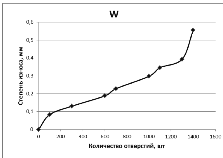
Рис.1. График зависимости износа задней поверхности режущего клина сверла от количества выполненных отверстий.
