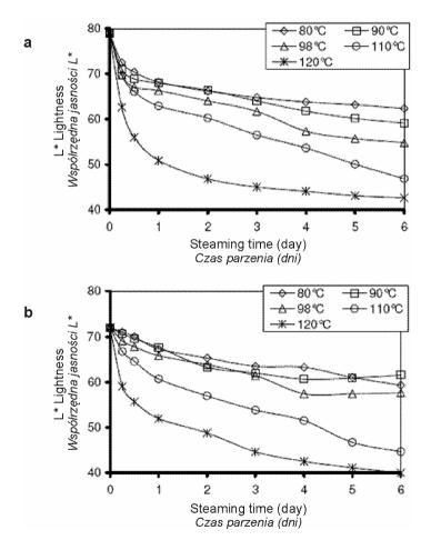
Fig. 1. Lightness change of white (a) and red (b) heartwood of beech (EMC = 47%) Rys. 1. Zmiana współrzędnej jasności (L\*) białej (a) i czerwonej (b) twardzieli drewna bukowego w procesie jego parzenia (EMC = 47%)
