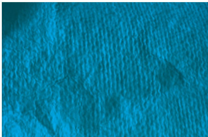
Figure 6. The long-fibrous cellulose of a hemp fibre Zdjęcie 6. Celuloza długowłóknista z włókna konopnego
