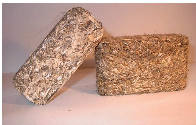
Figure 9. Briquettes made of hempen harls Zdjęcie 9. Brykiety wykonane z paździerzki konopnych
