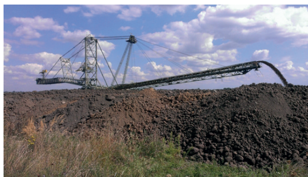
Figure 4. The covering of the excavation in the brown coal mine KWB Konin Zdjęcie 4. Zasypywanie wyrobiska w kopalni węgla brunatnego KWB Konin
