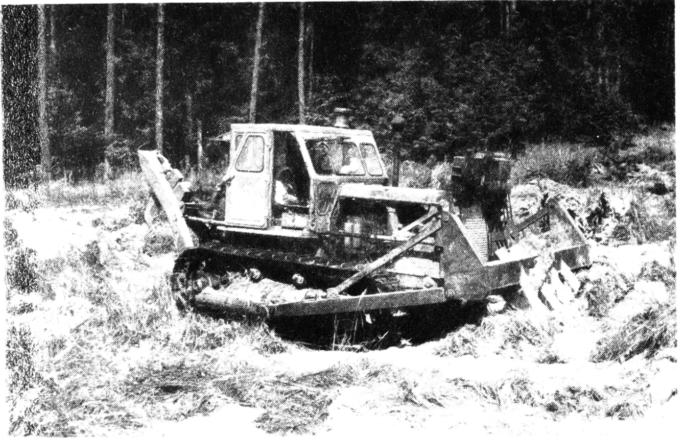
Ryc. 1. Urządzenie karczujące „Odyniec” zamontowane na ciągniku gąsienicowym T-100-M
