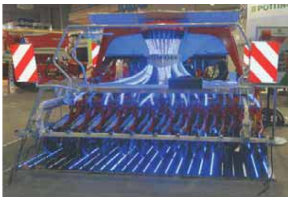
Rys. 4. Siewnik pneumatyczny AEROSEM (fot. S. Feder) Fig. 4. AEROSEM Pneumatic Seed Drill (photo S. Feder)
