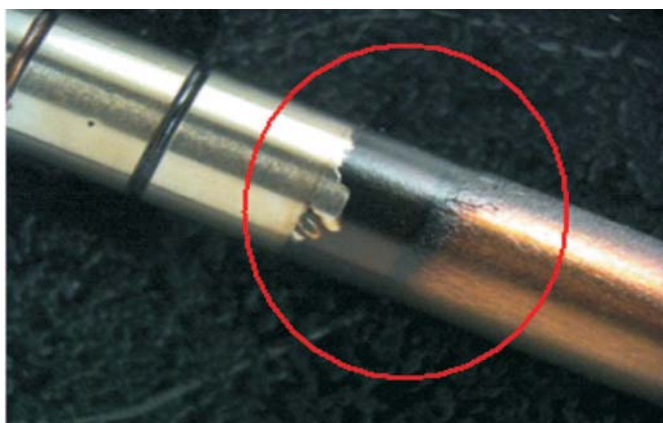
Rys. 13. Wżery korozyjne na popychaczu iglicy (rozpylacz Common Rail-Bosch)
