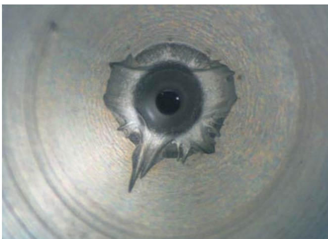
Rys. 15. Uszkodzenie gniazda zaworu sterującego (Common Rail-Bosch)
