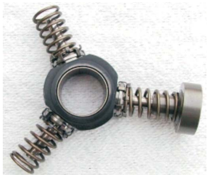
Rys. 11. Krzywka i sprężyny sekcji tłoczącej pompy Common Rail Fig. 11. Cam and springs of the pumping unit
