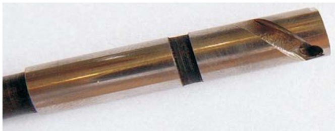
Rys. 3. Widok na rowek sterujący dawką paliwa. Znaczne patologiczne zużycie, widoczne liczne mikrowgłębienia, wżery (pow. 10x)*
