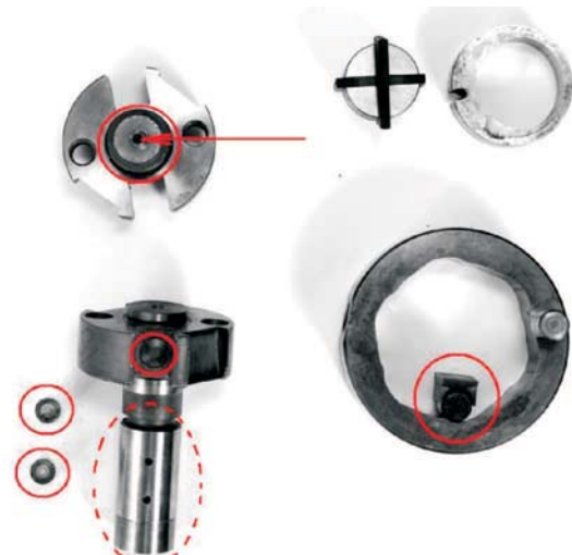
Rys. 6. Wybrane elementy pompy wtryskowej DPA firmy CAV podlegające intensywnemu zużyciu - zaznaczono miejsca zużyciu - z prawej w powiększeniu rozdzielacz obrotowy
