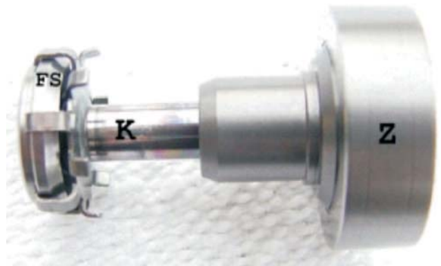
Rys. 10. Sekcja tłocząca pompy Common Rail Fig. 10. Pumping unit of the Common Rail pump
