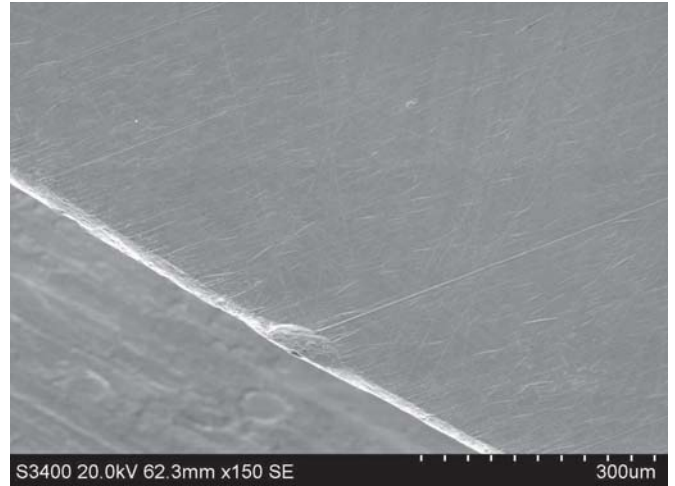
Rys. 5. Widok na rowek sterujący dawką paliwa (pow. 600x)*
