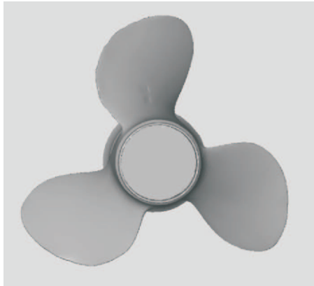
Rys. 3. Model 3D śruby napędowej jako rezultat poligonizacji chmury punktów otrzymanej w wyniku skanowania 3D skanerem ATOS II
