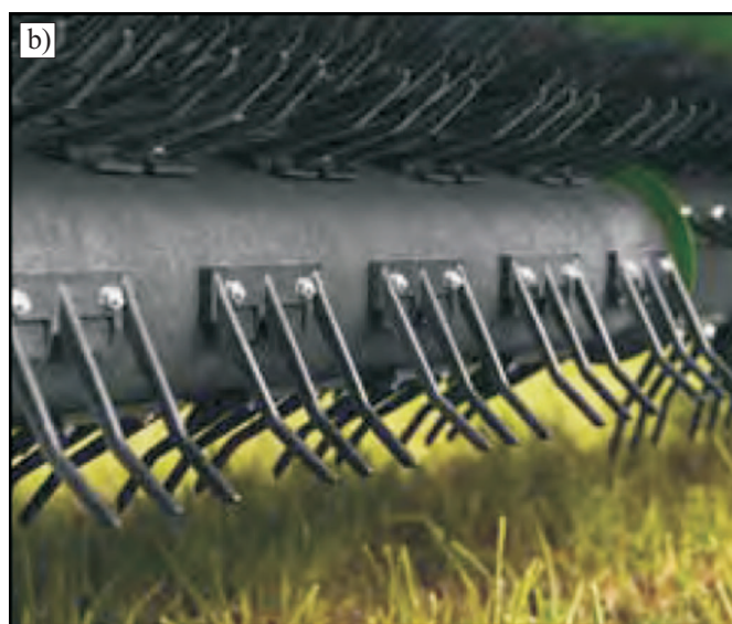
Rys. 1. Zgrabiarka z przenośnikami taśmowymi firmy H&S, model TWM12: a - widok maszyny, b - ustawienie palców w fazie podbierania, c - ustawienie palców w fazie przekazania materiału na poprzeczny przenośnik taśmowy [2]
