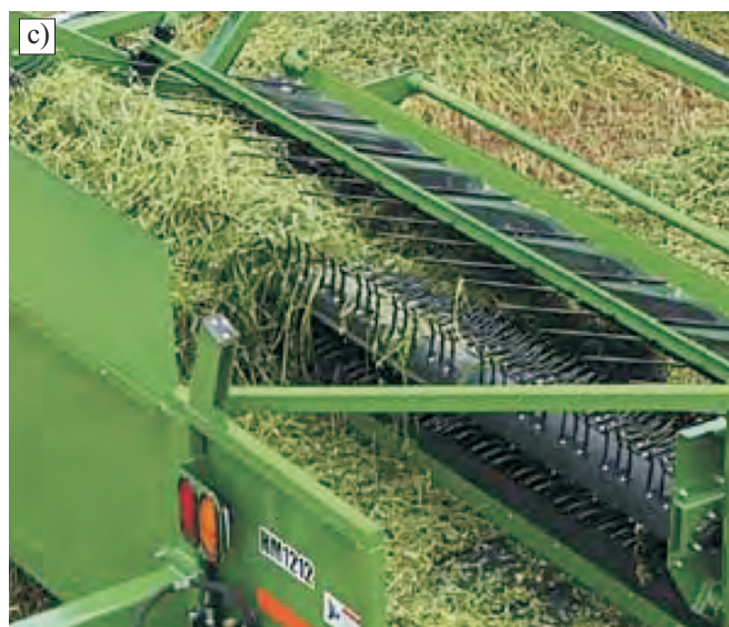
Rys. 1. Zgrabiarka z przenośnikami taśmowymi firmy H&S, model TWM12: a - widok maszyny, b - ustawienie palców w fazie podbierania, c - ustawienie palców w fazie przekazania materiału na poprzeczny przenośnik taśmowy [2]
