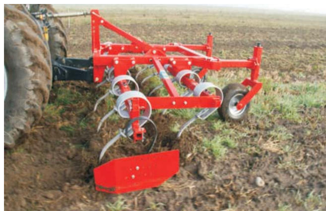
Rys. 1. Kultywator przedni podczas uprawy Fig. 1. Front cultivator during cultivation
