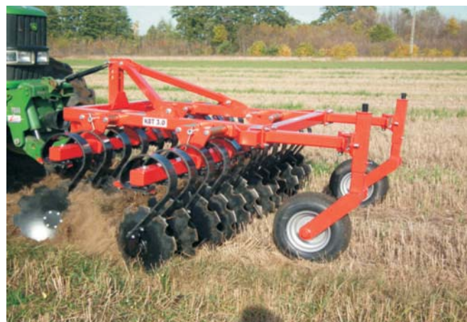
Rys. 4. Brona talerzowa przednia podczas uprawy ścierniska Fig. 4. Front harrow during stubble cultivation
