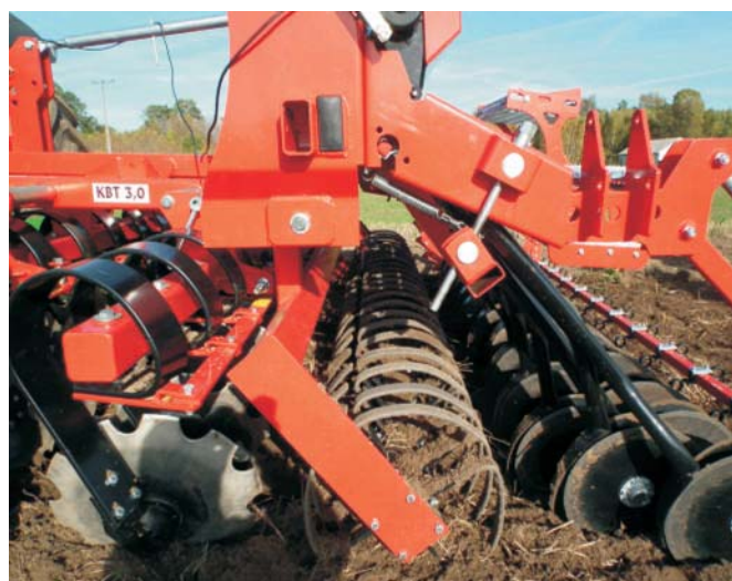
Rys. 10. Redlice siewnika ustawione są w śladach pierścieni wału Fig. 10. Coulters are arranged in the footsteps of the shaft rings
