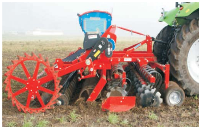
Rys. 9. Koła i wał pierścieniowy ustalają głębokość roboczą agregatu uprawowo-siewnego Fig. 9. Wheels and ring shaft set the working depth of the tilling-and-sowing unit
