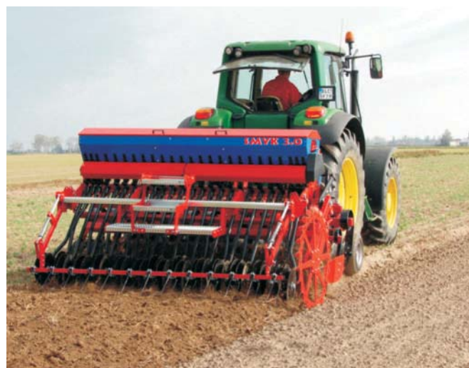
Rys. 5. Agregat uprawowo-siewny podczas pracy na podoranym ściernisku Fig. 5. Tilling-and-sowing unit while working on plowed stubble
