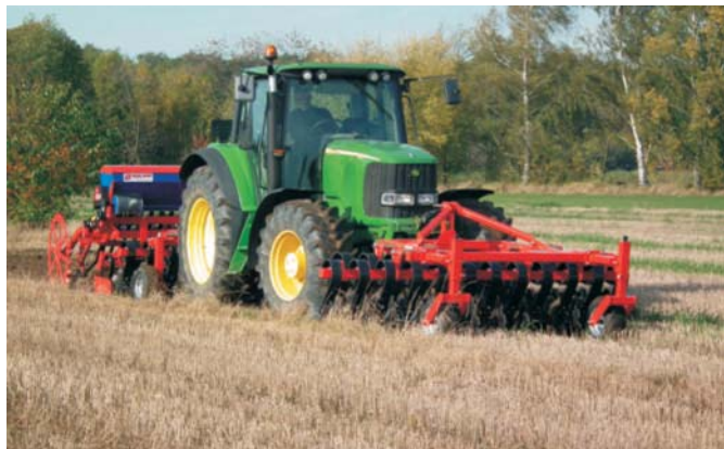
Rys. 6. Zestaw uprawowo-siewny podczas pracy na ściernisku Fig. 6. Tilling-and-sowing set while working on stubble
