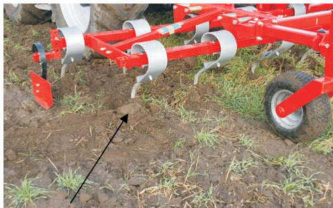
Rys. 2. Sprężyny zabezpieczają zęby przed kamieniami Fig. 2. Reinforcing springs protect tines against stones
