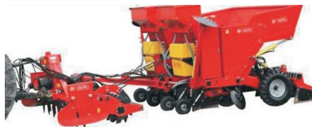
Rys. 3. Wieloczynnościowy agregat do sadzenia ziemniaków. Producent: Przedsiębiorstwo Produkcyjno-Usługowo-Handlowe AKPIL Kazimierz Anioł, Pilzno, Polska Fig. 3. A Multipurpose Unit For Planting Potatoes. Producer: Przedsiębiorstwo Produkcyjno-Usługowo-Handlowe AKPIL Kazimierz Anioł, Pilzno, Poland
