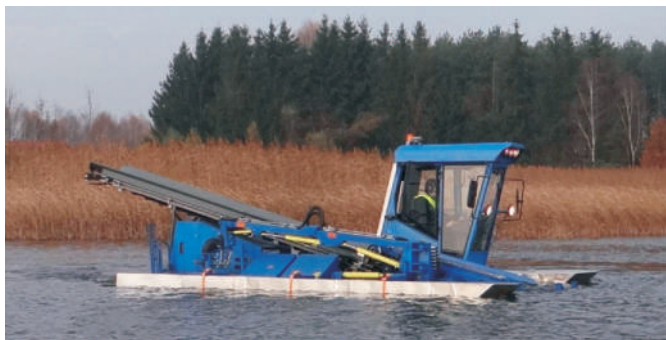
Rys. 2. Badania wyporności rzeczywistego modelu bazowego pojazdu gąsienicowego - miejsce: jezioro Bąblino Fig. 2. Displacement studies of the actual base model of the tracked vehicle - place: Bąblino Lake
