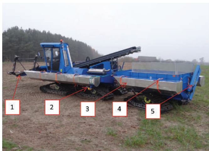
Rys. 3. Zestaw pojazdów gąsienicowych przygotowany do badań pływalności: 1 - zespół koszący roślinność podwodną, 2 - śruby napędowe, 3 - zbiorniki wypornościowe, 4 - wsporniki mocujące zbiorniki wypornościowe, 5 - składany podajnik śrubowy o zmiennym kątowym położeniu
