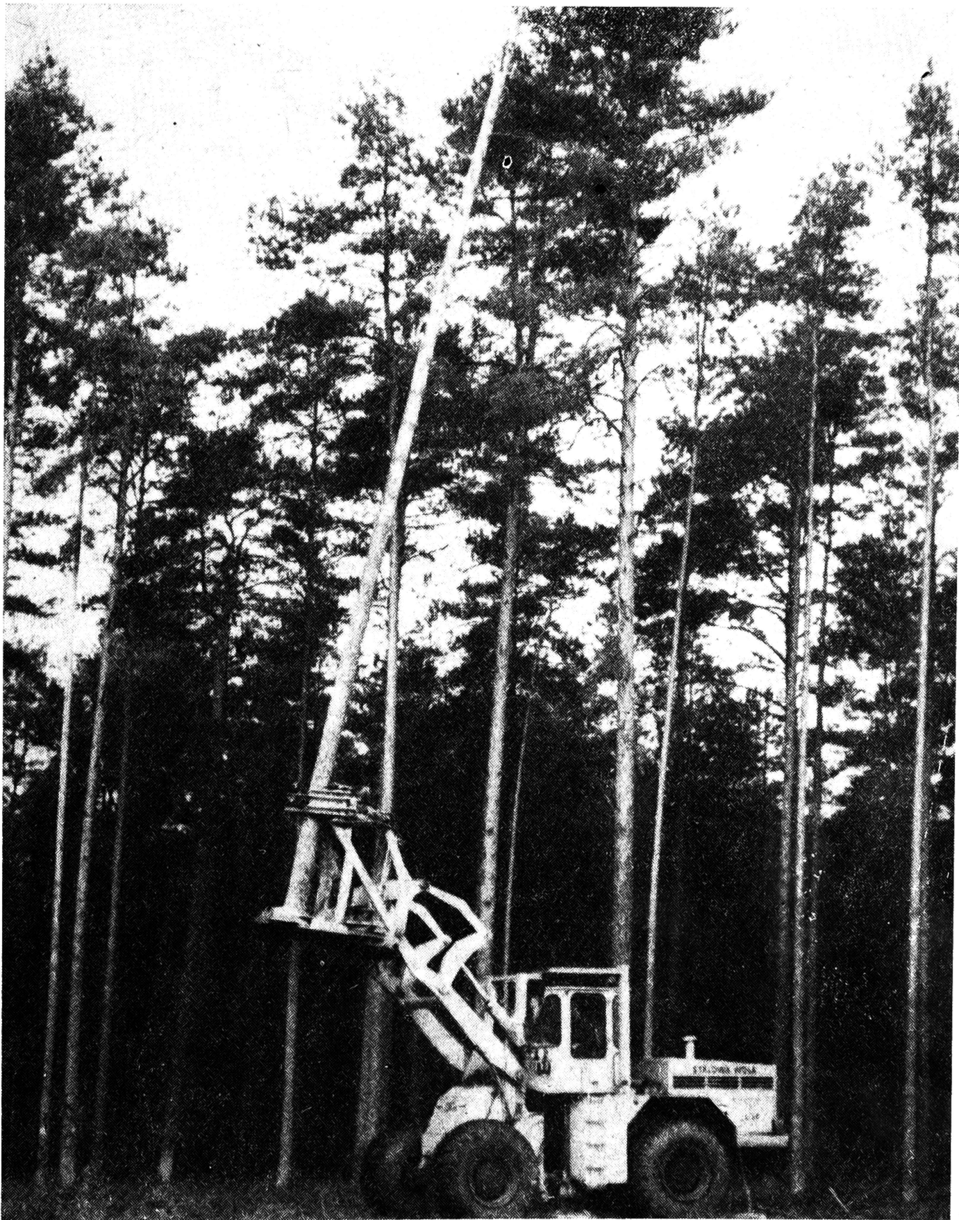
Ryc. 1. Maszyna ścinkowo-układająca z głowicą ścinkową ND-600, produkowana przez Zakłady Stalowa Wola na bazie ładowarki czołowej K-34
