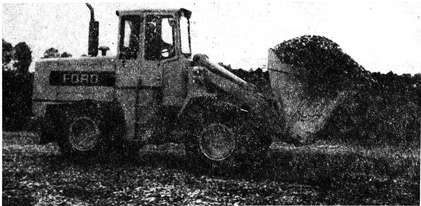
Ryc. 5. Ładowanie zrębków na wagony kolejowe za pomocą ładowarek czołowych produkcji krajowej L-2 lub importowanych firmy Ford, zaopatrzonych w łyżkę, przystosowaną do zrębków w wypadku konieczności transportowania zrębków na większe odległości transportem kolejowym
