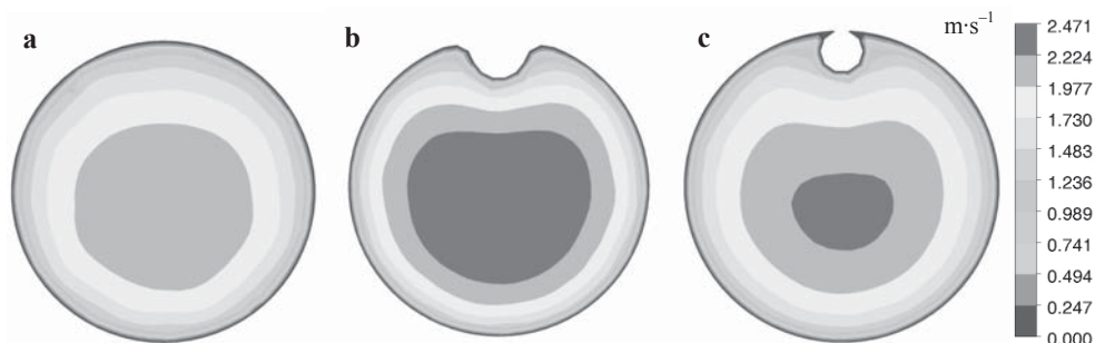
RYSUNEK 9. Przykładowy rozkład prędkości w: a – przewodzie kołowym, b – przewodzie kołowym ze światłowodem w powłoce renowacyjnej, c – przewodzie kołowym ze światłowodem bez powłoki renowacyjnej
