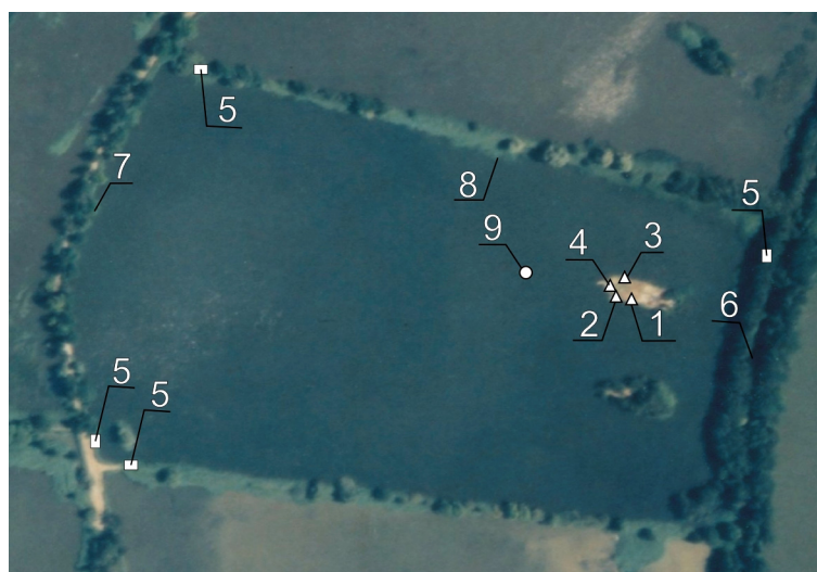
Rysunek 1. Staw Staś Górny: 1 – klatka meteorologiczna, 2 – heliograf, 3 –deszczo- mierz Hellmana, 4 – automatyczna stacja meteorologiczna, 5 – mnichy, 6 – doprowa- dzalnik, 7 – drzewa i krzewy, 8 – makrofity, 9 – punkt pomiarowy T Figure 1. Staś Górny pond: 1 –meteorological cage, 2 – heliograph, 3 – Hellman rain- gauge, 4 – automatic weather station, 5 – monks, 6 – water supply ditch, 7 – Trees and shrubbery, 8 – aquatic macrophytes, 9 – measurement point T
