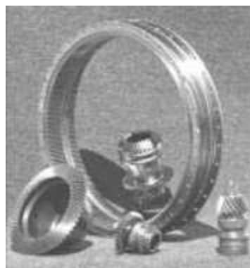
Rys. 5. Części helikoptera wykonane na bazie stopu Fe-Al [17] Fig. 5. Helicopter components made with Fe-Al alloy [17]
