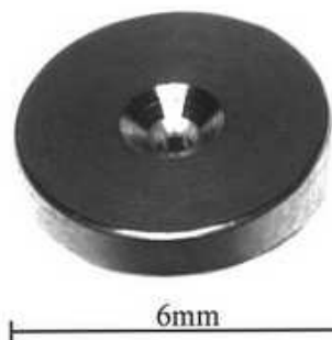
Rys. 4. Element wtryskiwacza paliwa wykonane na bazie stopu Fe-Al [12]
