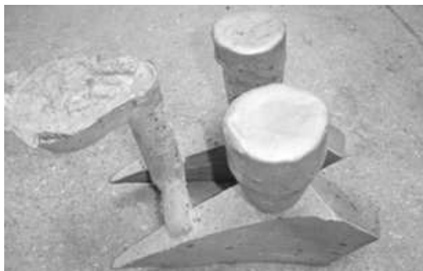
Rys. 3. Odlew wraz z układem wlewowym i nadlewem po oczyszczeniu z masy Fig. 3. Casting with rise and feeding system after cleaning
