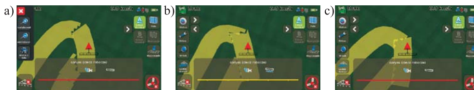
Rys. 12. Wizualizacja wyników pracy dla trzech wariantów podwójnego pokrycia: a) 1%, b) 50%, c) 99% Fig. 12. The results of the sprayer's work for three variants of the overlap: a) 1%, b) 50%, c) 99%
