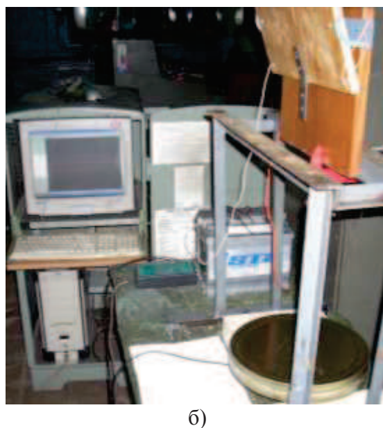
Рис. 2. Принципиальная схема (а) и общий вид (б) установки для определения коэффициента сопротивления воздуха при падении зерна.
