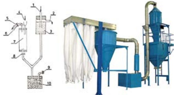
Rys. 7. Schemat elutriatora: 1- dopływ wody, 2- wypływ wody nadmiarowej, 3- zbiornik zapewniający stałe ciśnienie, 4- lejek do wprowadzania próbki, 5- zawór, 6- wypływ frakcji drobnoziarnistej, 7- kolumna rozdzielacza, 8, 9- zawory, 10- pojemnik na frakcję gruboziarnistą.
